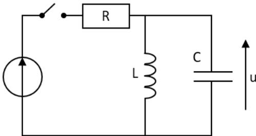
L'interrupteur est ouvert depuis longtemps et le condensateur déchargé, quand on le ferme à un instant qu'on choisit comme origine des temps.
