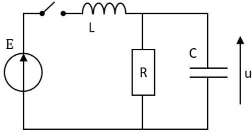
Pour  $t < 0$ , le condensateur est déchargé et aucun courant ne circule dans le circuit. À  $t = 0$ , on ferme l'interrupteur. On donne :  $R = 100 \Omega$ ,  $C = 1,0 \text{ nF}$ ,  $L = 1,0 \text{ mH}$ .
